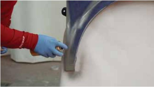
*Imprimación anticorrosiva en aerosol*
