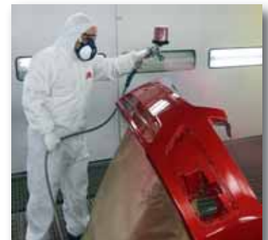
Aplicación de acabado monocapa UHS
