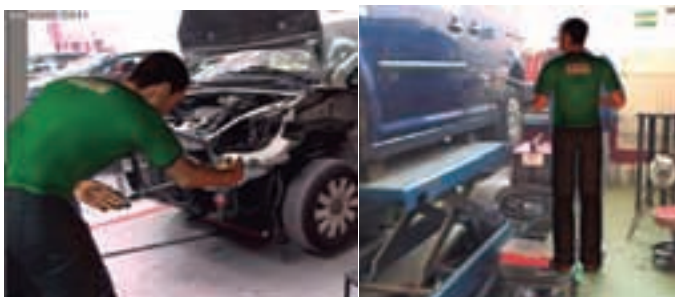
Imágenes: Trabajos de reparación de chapa: vehículo en suelo y sobre elevador.
