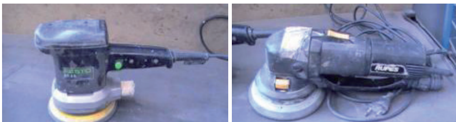
Lijadoras rotorbital eléctricas. (pesos promedios que oscilan entre 1 y 2 Kg.)
