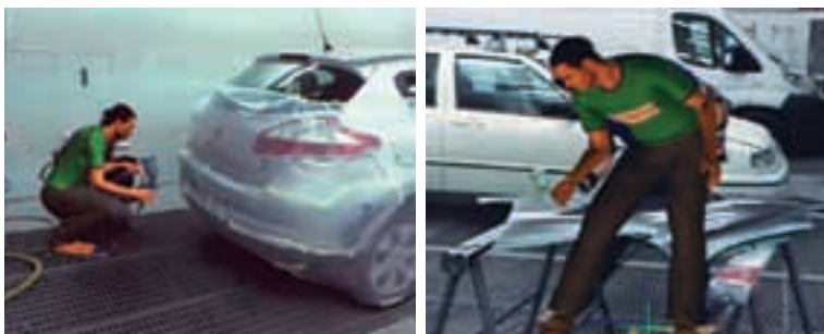
Imágenes: Aplicación de pintura: interior de cabina y pieza sobre caballetes.
